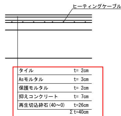
ロードヒーティング舗装部
