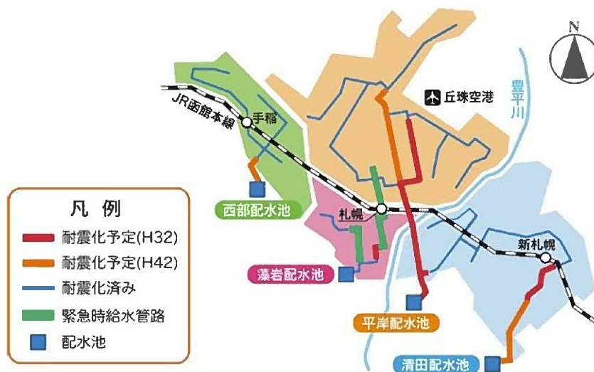
【図表34】配水管連続耐震化整備路線図
