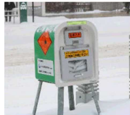
交差点に設置された砂箱
