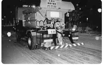
凍結防止剤や砂をまく散布車。幹線道路では除雪後にまくことが多い
