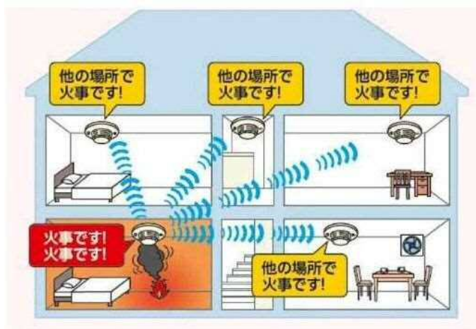
連動型住宅用火災警報器の仕組み
