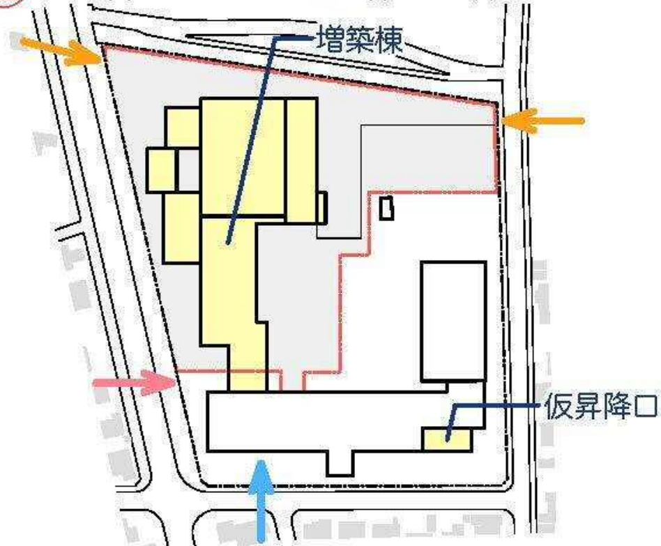
② 仮昇降口の整備と増築棟の建設
