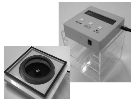
札幌市青少年科学館「放射線実験セット」 右：霧箱 左：遮蔽実験装置
