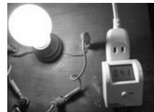
消費電力を測定する様子
