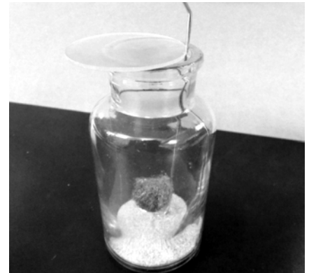
図6 燃焼さじによる加熱
