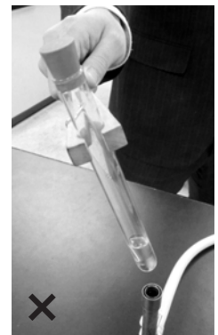
図4 試験管での加熱悪い例
