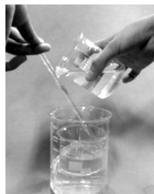
図7 濃硫酸の薄め方
