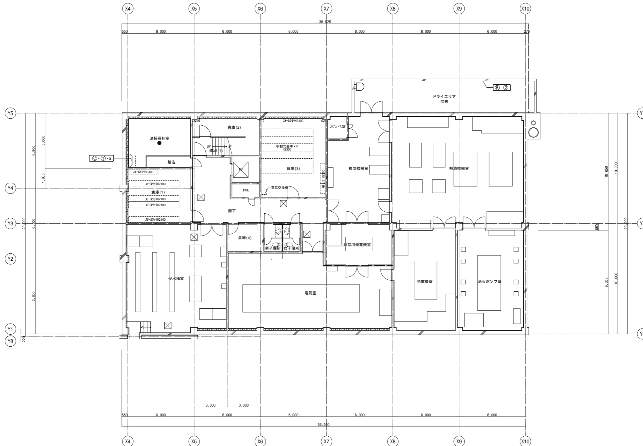
地下1階平面図(改修前) 1/100 倉庫1、倉庫3に示す残置備品は適宜移動の上、工事を行うこと (C)-①-g
