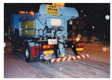
凍結防止剤散布の様子
