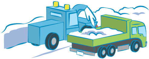
運搬排雪 道路脇の雪をダンプトラックに積みます。
