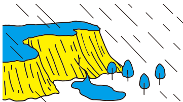
斜面から水がわき出す
