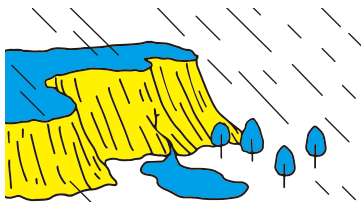
斜面から水がわき出す
