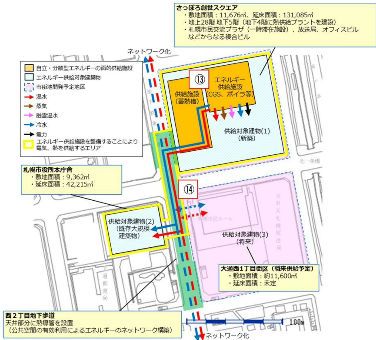
図 15 札幌駅・大通駅周辺地区都市再生安全確保計画図 ⑬札幌市北1西1周辺街区自立・分散型エネルギー供給施設及び⑭西2丁目地下歩道熱導管ネットワーク 詳細
