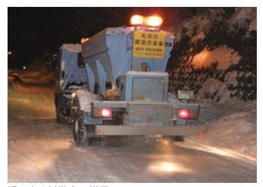
滑り止め材散布の様子
