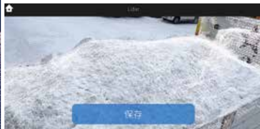
LiDARが照射され雪の3次元形状データをリアルタイム取得
