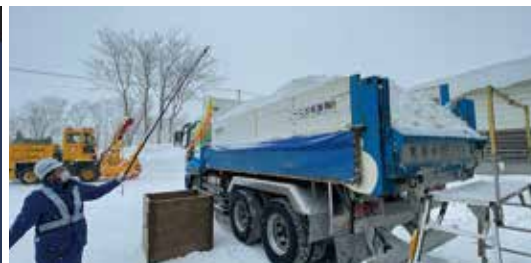
安全性も向上。従来はダンプの縁に立ちテープを用いて積載量を計測していた。
