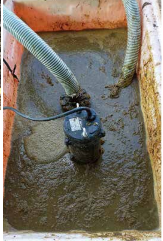
ポンプ通水試験の様子。糞尿に麦稈が混ざっているのがわかる。
