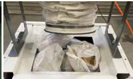
プレス装置が膨らみゴミを3分の1に圧縮する。
