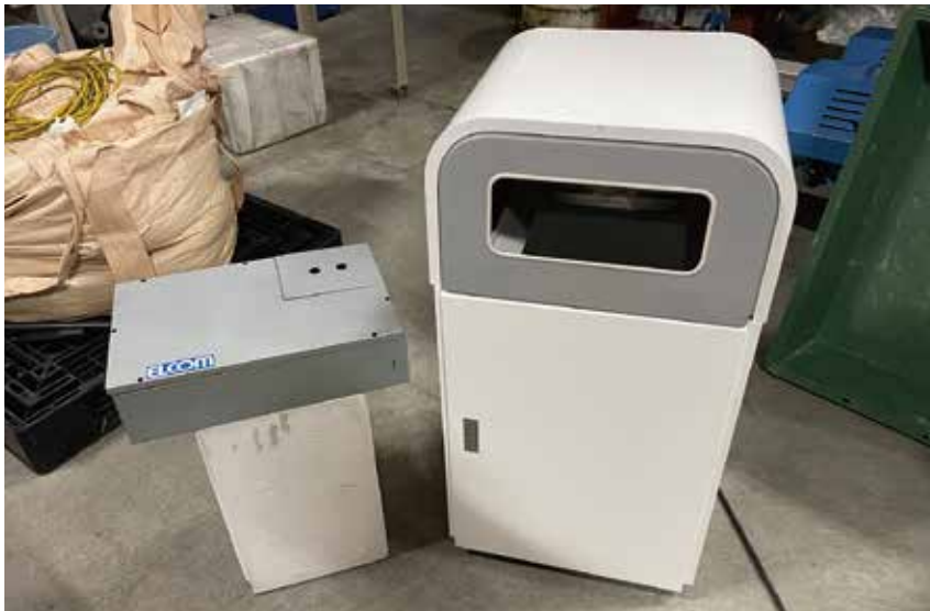
開発したゴミ圧縮ユニットは既存のゴミ箱に簡単に設置できる大きさだ。
