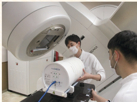
図2 三次元検出器を用いた事前検証業務の様子
