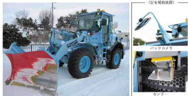
2名乗車型タイヤショベルへの安全補助装置設置状況
