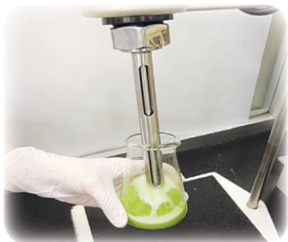
図1 農薬を試薬に溶かし出しているところ
